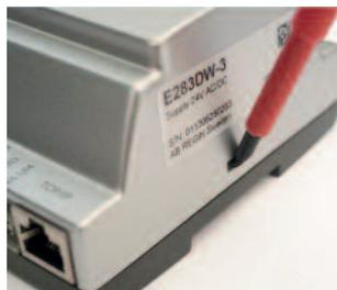
Premere sulle clip presenti su ciascun lato dell'alloggiamento con un piccolo giravite per rimuovere il coperchio dalla base. Mantenere la base e rimuovere il coperchio.
