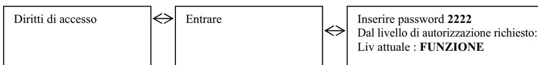
Immettere il codice 2222 mediante i pulsanti direzionali, poi confermare con OK. Pigiare 2 volte sulla freccia di sinistra per accedere ai menù. In caso di errore di digitazione pigiare 2 volte la freccia C e ripetere l'operazione
